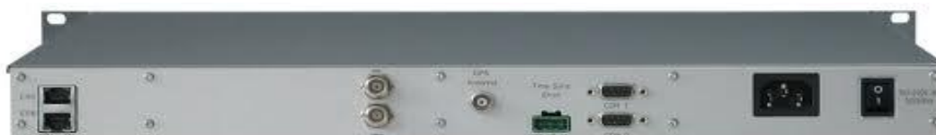
Rys. 63 Serwer czasu widok tył
